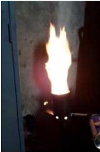
Gambar 2. Nyala Api di Burner Hasil Uji Pembakaran Gas Produser
