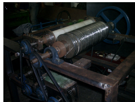
Gambar 17. Sub Asembli rol pisau potong dan poros nilon penahan.
