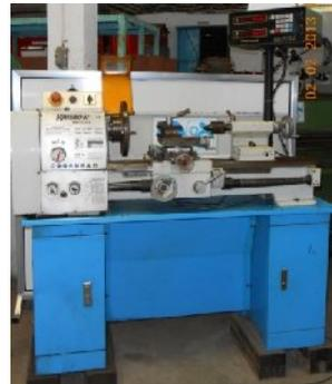
Gambar 3.1. Mesin bubut dan *Linear movement display*
