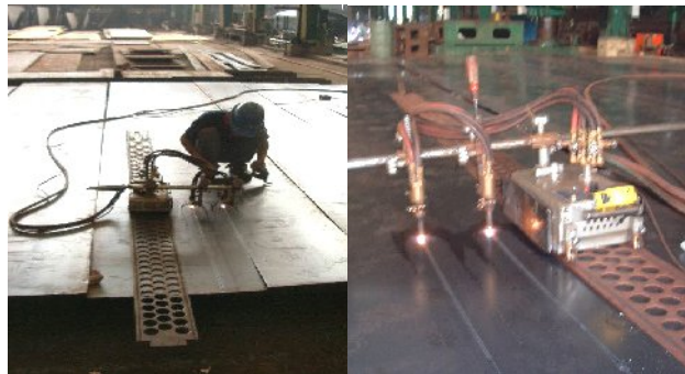
Gambar 12. Proses pemotongan plat baja
