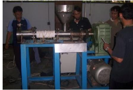
Gambar 2. Foto konstruksi mesin ekstruder
