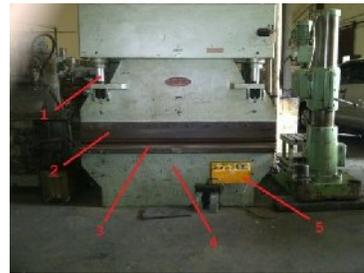
Gambar 1. Mesin Tekuk Plat Tenaga Hidrolik
