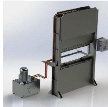
Gambar 10. Model Tiga Dimensi dari Rancangan Mesin Tekuk Plat
