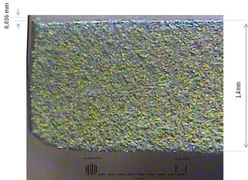
Gambar 17. Ketinggian burr 0,036 mm pada tebal material 1,4 mm.
