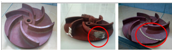
Gambar 4. a) Impeler kondisi baik, b) Impeler kondisi rusak pada ujung sudunya, c) Impeler kondisi pecah pada salah satu sudunya.
