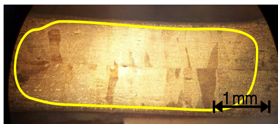
Gambar 3. Nugget pada waktu pengelasan 2 detik
