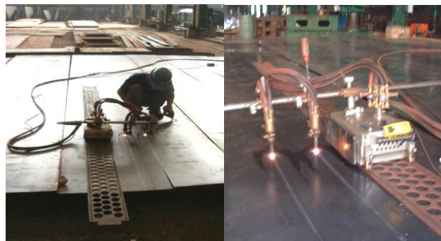
Gambar 12. Proses pemotongan plat baja
