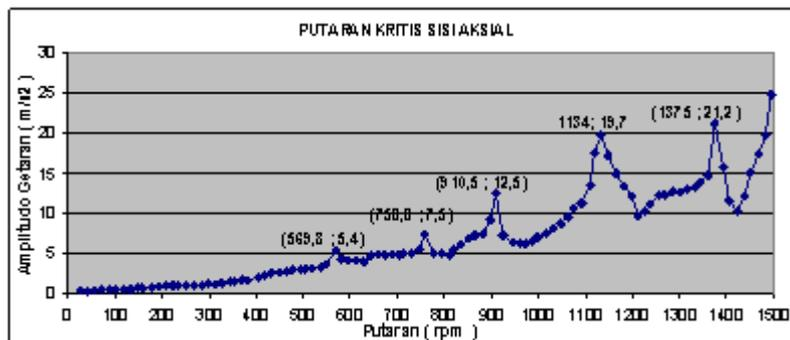
Gambar 11. Penentuan putaran kritis sistem poros - piringan yang terukur pada bantalan sisi NEAR arah aksial.
