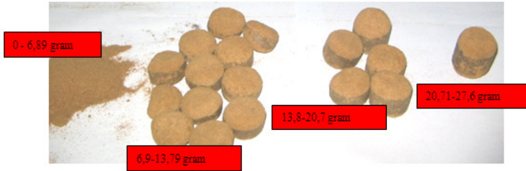
Gambar 2. Hasil uji ketahanan briket biomasa tekanan pembriketan 600 kg/cm 2 dan waktu penahanan 40 detik.
