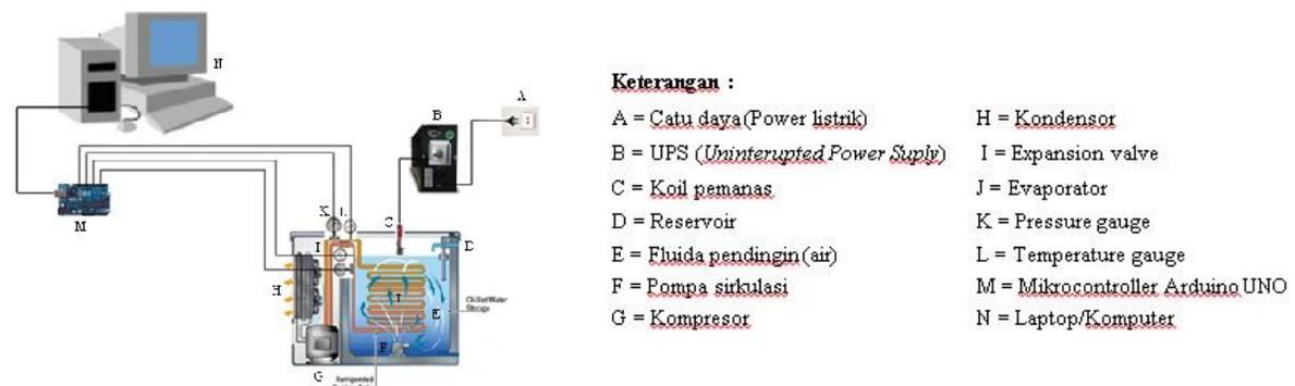
Gambar 2.1 Skema Alat Uji Perubahan Fase dengan *Heat Flux* konstan
