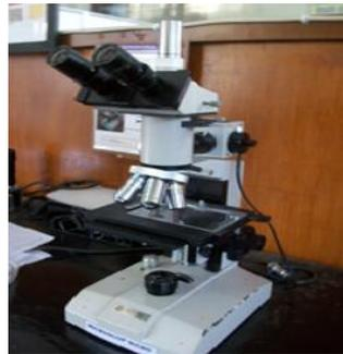
Gambar 4.5. Alat uji metalografi mikro merk Olympus
