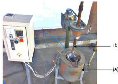
Gambar 4.1. Peralatan *stir casting*; a. Tungku peleburan; b. Batang pengaduk
