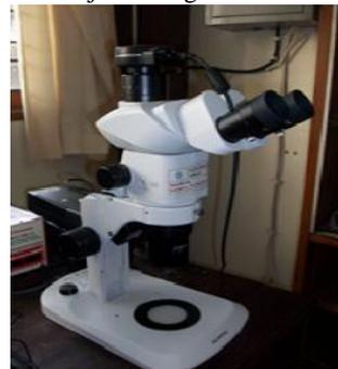
Gambar 4.6. Alat uji metalografi makro merk Olympus
