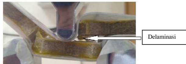
Gambar 3.3 Delaminasi skin dan core pada komposit sandwich cantula-rHDPE dengan adhesive epoxy (versamid) .
