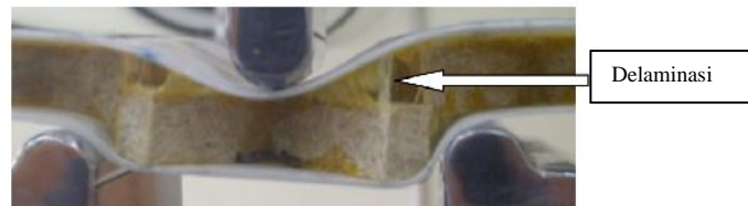
Gambar 3.4 Delaminasi skin dan core pada komposit sandwich cantula-rHDPE dengan adhesive chloroprene (aica-aibon) .
