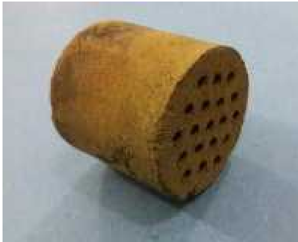
Gambar 2. Material Filter dari Keramik
