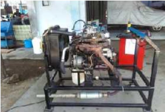
Gambar 4. Mesin Toyota Kijang 5 K
