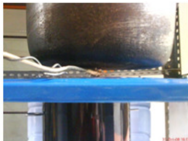
(a) Panci setelah uji WBT dengan minyak tanah terlihat hitam.
