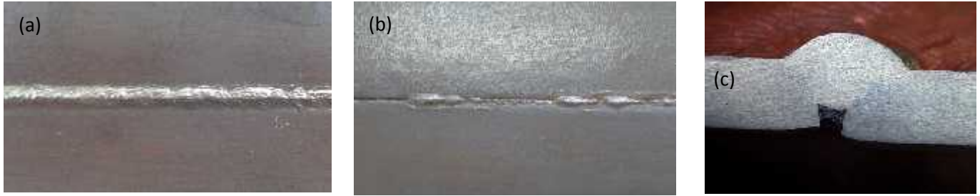
Gambar 7. Pengamatan visual hasil pengelasan pada Heat input 678 J/mm dengan : (a) tampilan cover pass, (b) tampilan root pass, (c) tampilan melintang.
