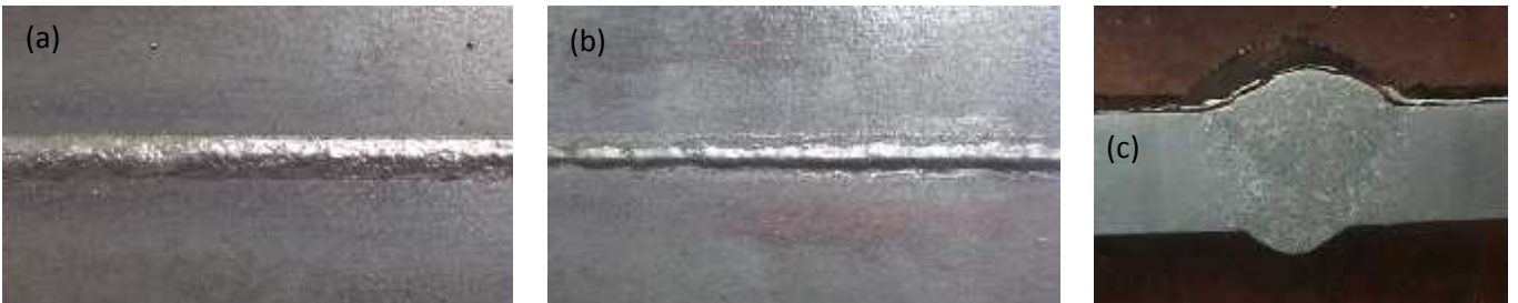
Gambar 6. Pengamatan visual hasil pengelasan pada Heat input 756 J/mm dengan : (a) tampilan cover pass, (b) tampilan root pass, (c) tampilan melintang.
