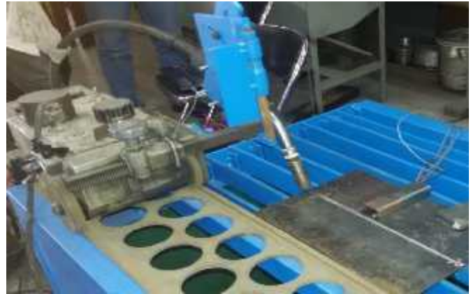
Gambar 1. Welding rig untuk las GMAW
