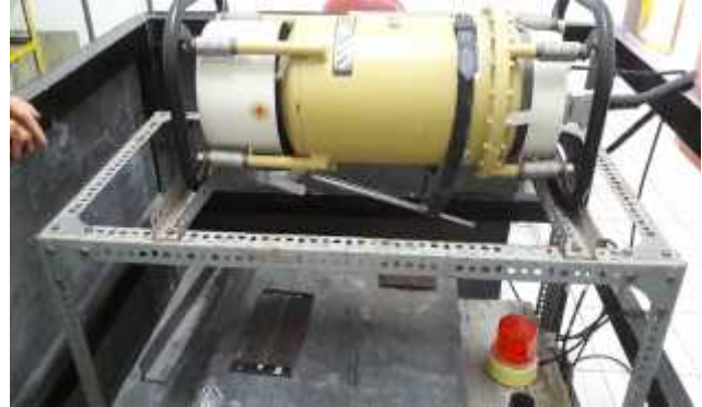
Gambar 2. Peralatan uji radiografi pada spesimen las.
