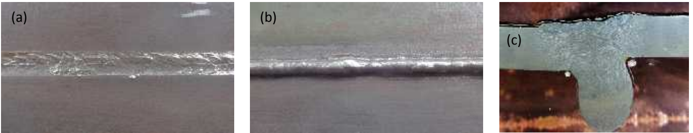
Gambar 3. Pengamatan visual hasil pengelasan pada Heat input 1001 J/mm dengan : (a) tampilan cover pass, (b) tampilan root pass, (c) tampilan melintang.
