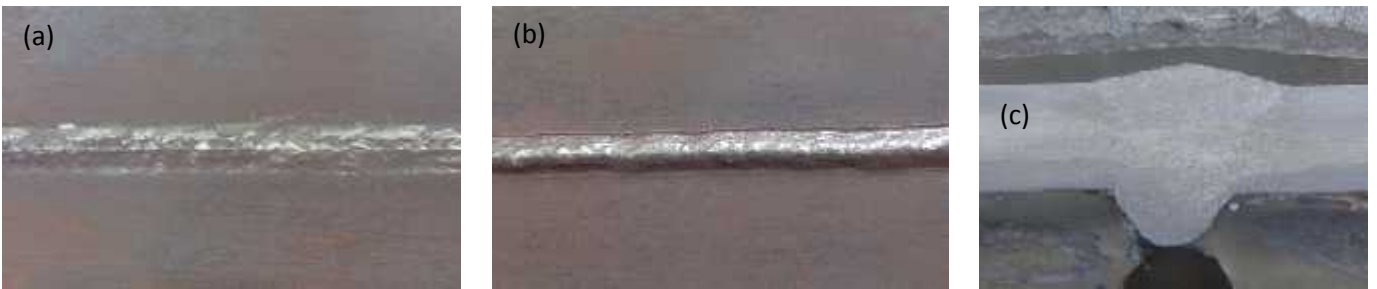
Gambar 4. Pengamatan visual hasil pengelasan pada Heat input 936 J/mm dengan : (a) tampilan cover pass, (b) tampilan root pass, (c) tampilan melintang.
