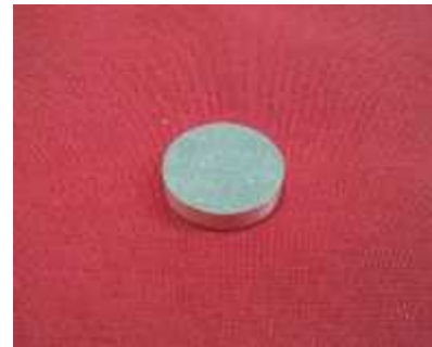
Gambar 2. Spesimen uji korosi
