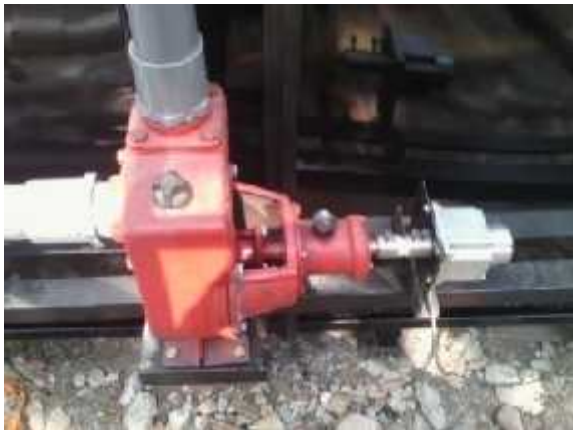
Gambar 2.4 PAT yang dihubungkan dengan Generator
