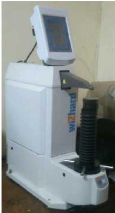
Gambar 2.3 Alat uji kekerasan Rockwell B
