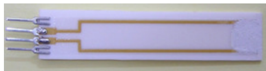
Gambar 11. Prototipe sensor gas CO yang telah dilapisi SnO 2
