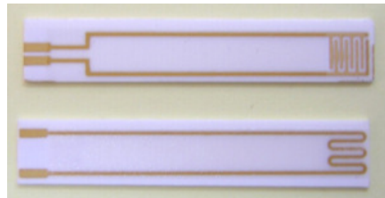
Gambar 10. Prototipe sensor gas CO yang belum dilapisi SnO 2
