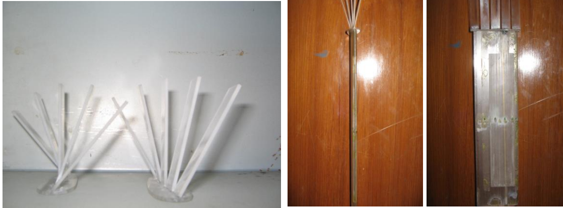
Gambar 1. Twisted multiple winglets dan Airfoil NACA 0012 dengan penambahan twisted multiple winglets
