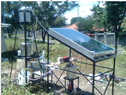
Gambar 6. Kolektor surya untuk distilasi etanol.
