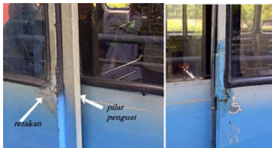
Gambar 1 Retakan pada pilar di sudut kaca dekat pintu.
