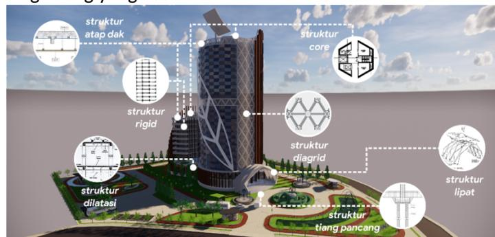
**Gambar 5. Struktur pada bangunan**
