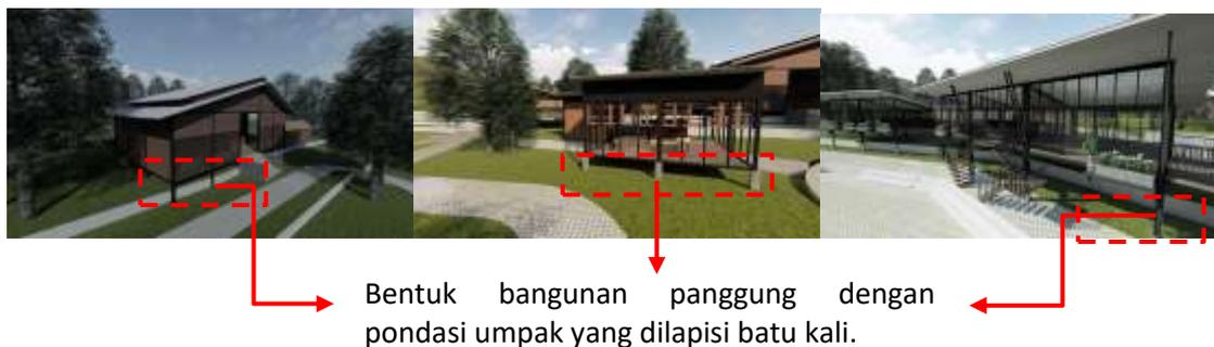
Bentuk bangunan panggung dengan pondasi umpak yang dilapisi batu kali.
