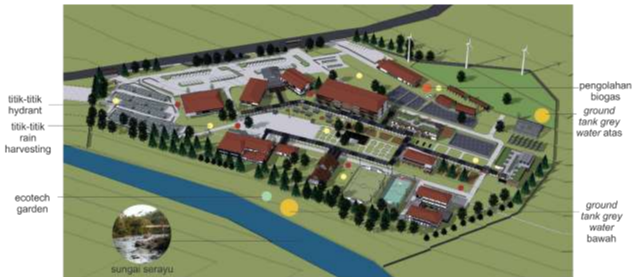
Gambar 19 Titik-titik Utilitas Pengolahan Air Pada Kawasan
