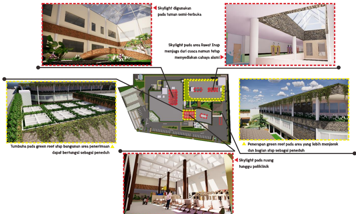
Gambar 8 Pemanfaatan Skylight dan Green Roof Sebagai Bentuk Integrasi Alam dan Bangunan
