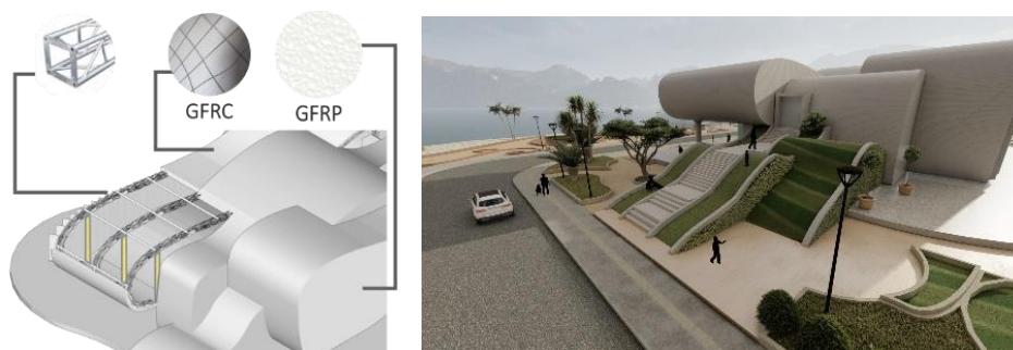
Gambar 10 Konsep Pemilihan Struktur Material Bangunan
