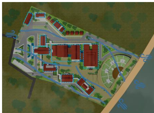
Gambar 12 Pemilihan Bentuk Bangunan Memanjang Mengikuti Arah Datangnya Angin
