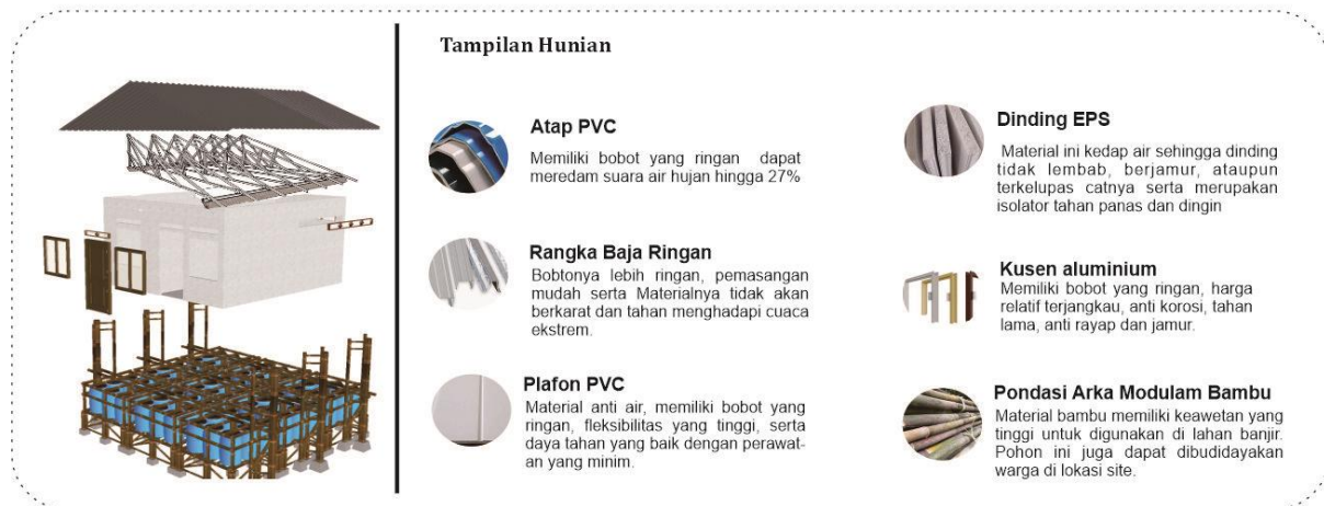
Gambar 13 Penerapan Material Pada Bangunan Amfibi
