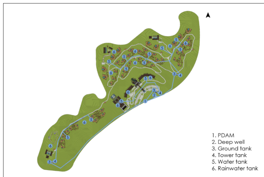
Gambar 9 Sistem Utilitas Air Bersih
