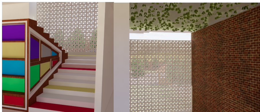
Gambar 3 Penggunaan Roster pada Dinding
