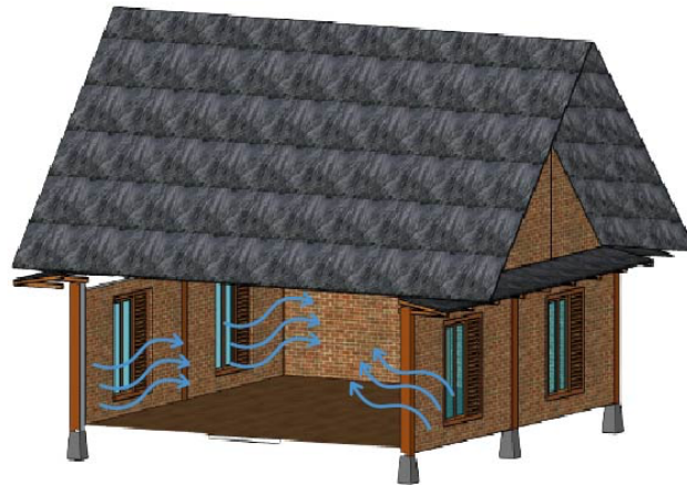
Gambar 4 Penerapan Cross Ventilation pada Bangunan
