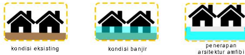
Gambar 8 Skenario Banjir dan Penerapan Arsitektur Amfibi
