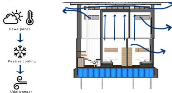
Gambar 24 Sistem Passive Cooling dan Pengaplikasiannya pada Hunian
