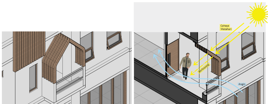
Gambar 9 Alat Pembayang Matahari pada Area Balkon
