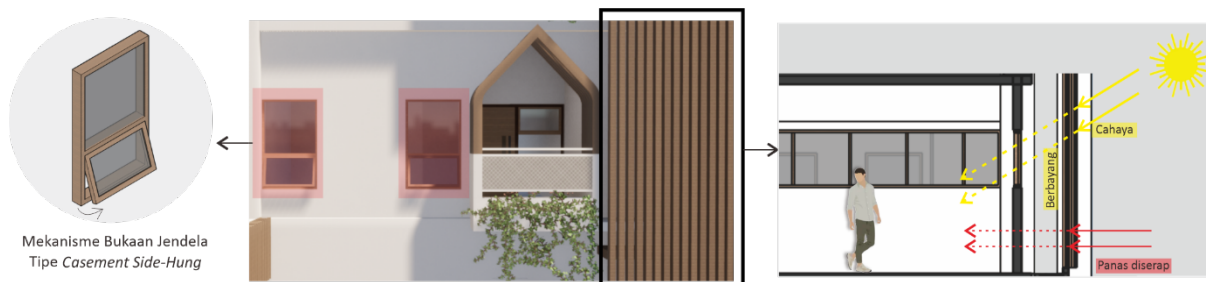
Gambar 4 Desain Dinding pada Bangunan dengan Penerapan Buka-tutup dan Penyerap Panas
