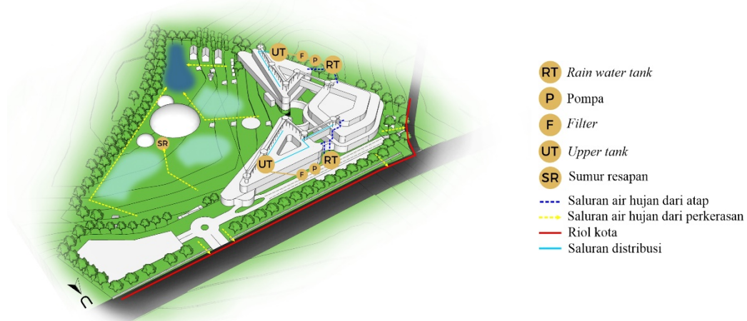
Gambar 10 Skema Jaringan air hujan
