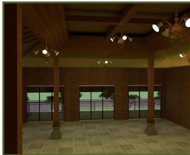
Gambar 13 Penerapan Struktur Atap Jawa Model Tumpangsari Dalam Pada Rancangan Bangunan Pasar Wisata Kerajinan
