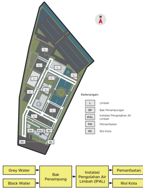
Gambar 12 Konsep Utilitas Air Kotor
