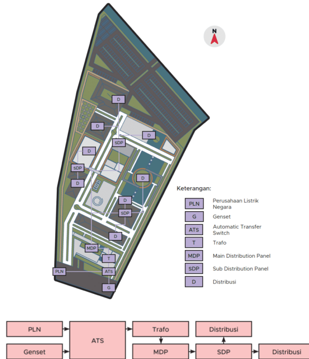
Gambar 15 Konsep Utilitas Jaringan Listrik
