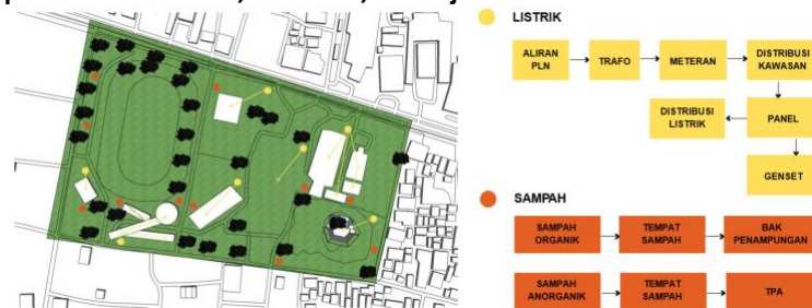
Gambar 10 Konsep Utilitas Jaringan Listrik dan Sampah Kawasan Taman Sriwedari
