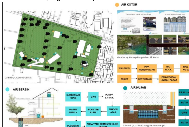
Gambar 9 Konsep Utilitas Air Bersih, Air Kotor, Air Hujan Kawasan Taman Sriwedari
