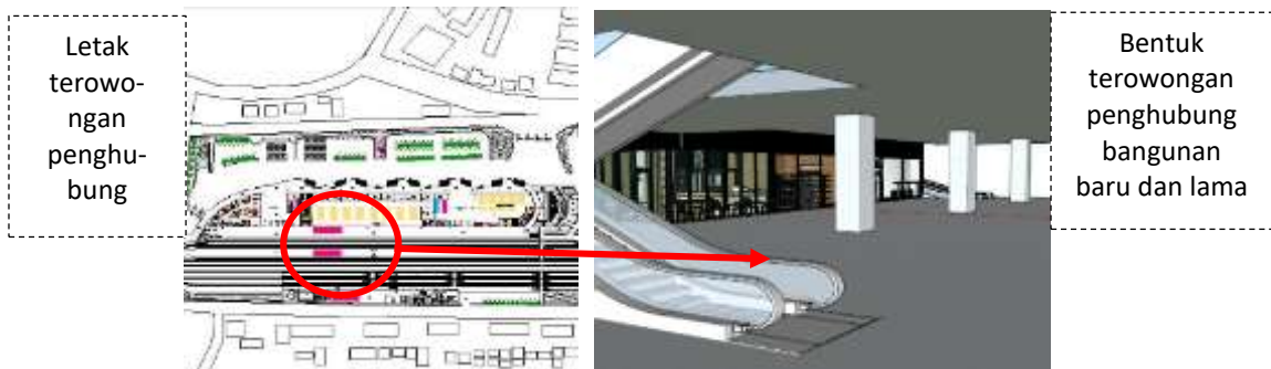
Gambar 14 Terowongan bawah tanah sebagai media penghubung bangunan existing dengan bangunan baru
