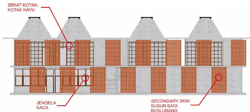
*Secondary skin* dari susunan batu bata membuat *filter* pada ruang-ruang dibelakangnya sehingga terlindung dari sinar dan panas matahari langsung. sekat kotak-kotak kayu yang transparan dan bukaan lebar pada pintu dan jendela membuat kesan terbuka pada ruangan namun masih terlindungi *secondary skin*.
